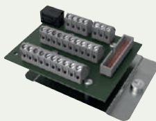
Opcjonalna płytk sterująca z funkcjami dodatkowymi (podłączenie z pompą ciepła, grzałki, chłodnice)
